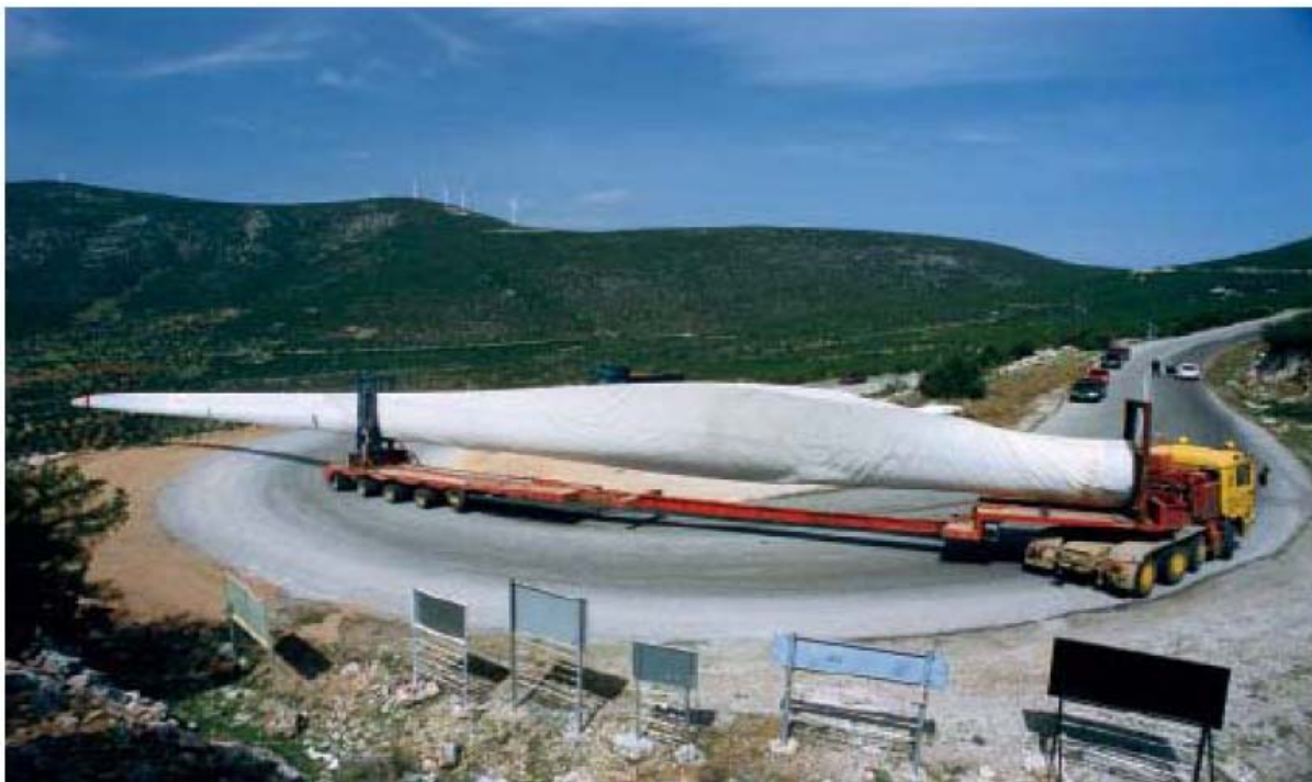
Figur 6. Transport av komponentar til vindgeneratorar kan vere ei stor utfordring. Ofte må det byggast nye vegar og kaianlegg. Foto: Vestas.
