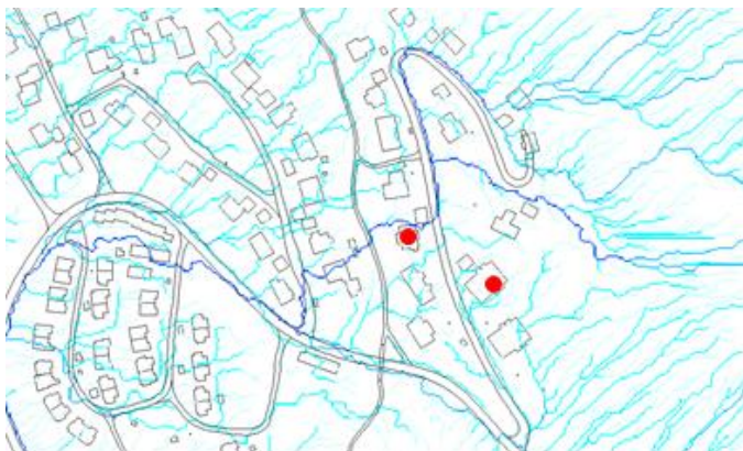
Figur 14 Eksempel på kobling av skadedata (røde punkt) med kartlag som viser flomveier (blå streker) for avdekking av potensielt skadelige flomveier
