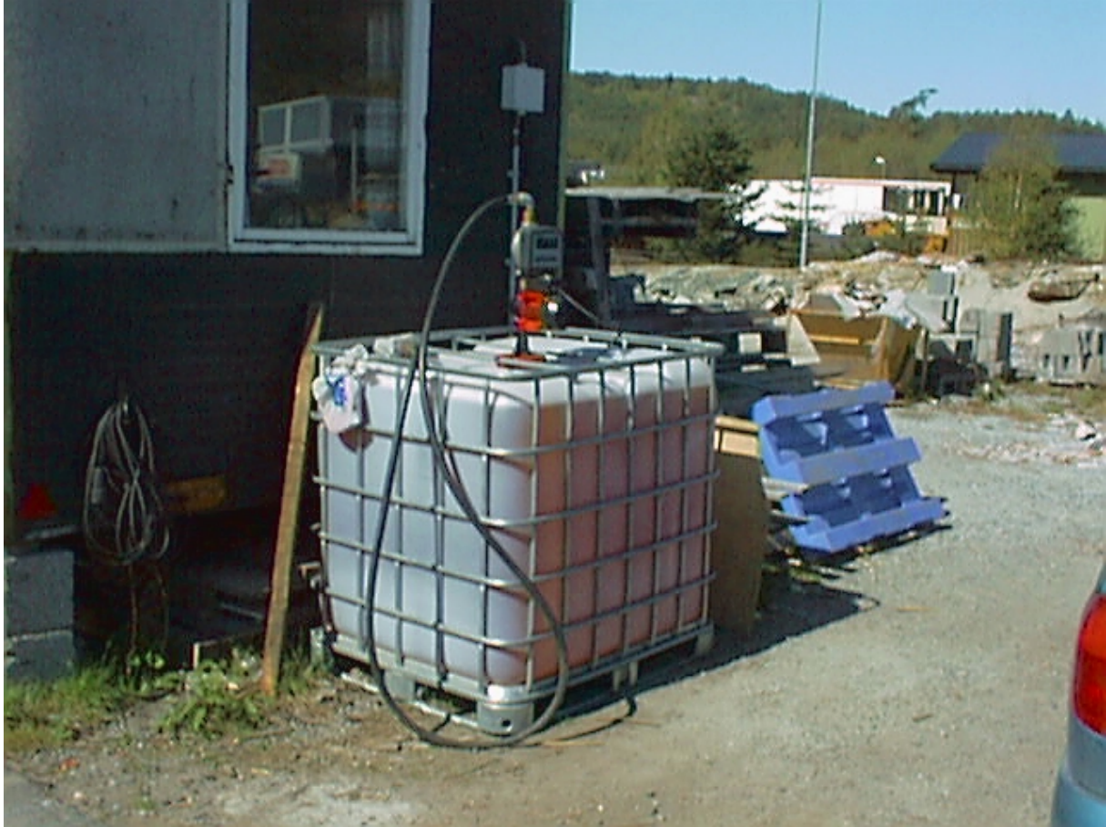
Figur 2 Tank med påmontert pumpe fotografert under testperioden med biodiesel hos Eineteig Transport
