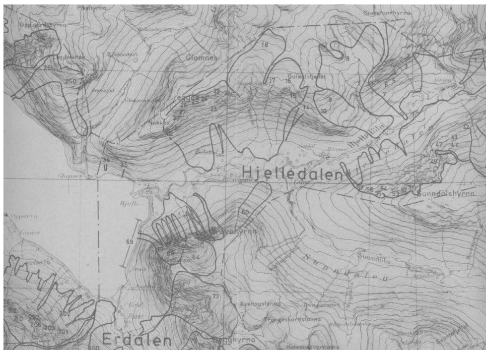
Figur 4. Kart over snøskred i Hjelledalen (NGI 1977). Utbreiing av skreda er avgrensa med svart strek. Difor er dette meir nyttig informasjon for arealplanlegging enn punktinformasjonen om historiske skred på Skrednett.
