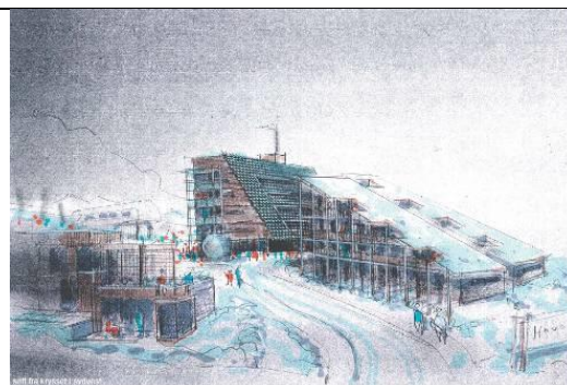
Figur 3: Hovdinntunet består av rekkehus og et leilighetsbygg i seks etasjer der det er integrert et solpanel i den største skrå takflaten. Prosjektet blir, hvis det blir bygget, det høyeste huset på Oppdal
